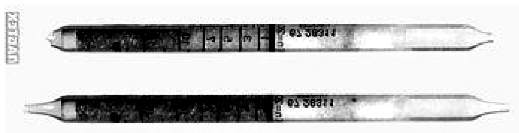
Рис. 11. Индикаторная трубка до и после анализа
