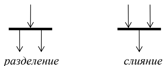
Рис. 4.24. Графическое изображение разделения и слияния параллельных потоков управления
