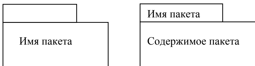
Рис. 2.20. Графическое изображение пакетов в языке UML
