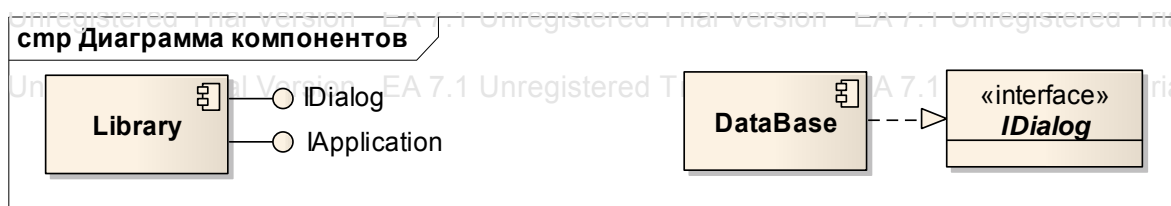
Рис. 5.6. Графическое изображение интерфейсов на диаграмме компонентов
