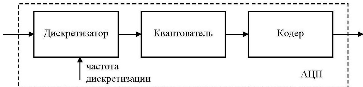
Рис. 1.2. Структурная схема аналого-цифрового преобразования
